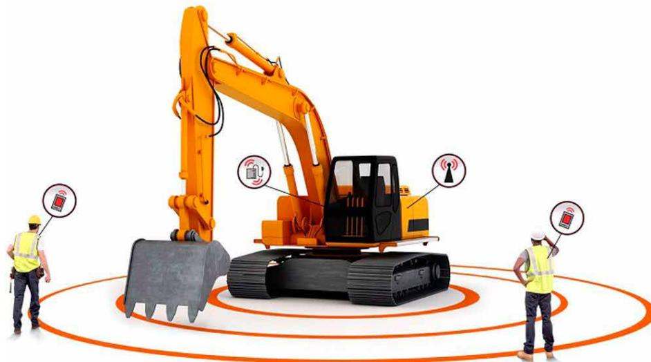
Pour prévenir le risque de collision engin-piéton et diminuer le nombre d'accident sur les chantiers, Kiloutou a développé en partenariat avec T2S un dispositif de prévention des collisions engin-piéton : KARE. Une solution connectée dotée de 3 alertes bidirectionnelles pour assurer sécurité et visibilité sur les sites et les chantiers.
